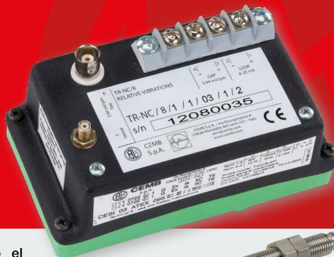
El transmisor TR-NC/8 mide las vibraciones relativas o el desplazamiento axial de un eje con respecto a un soporte y puede interactuar directamente en una técnica de 2 hilos (circuito de corriente 4 ÷ 20 mA) con un sistema de adquisición (PLC o DCS).
