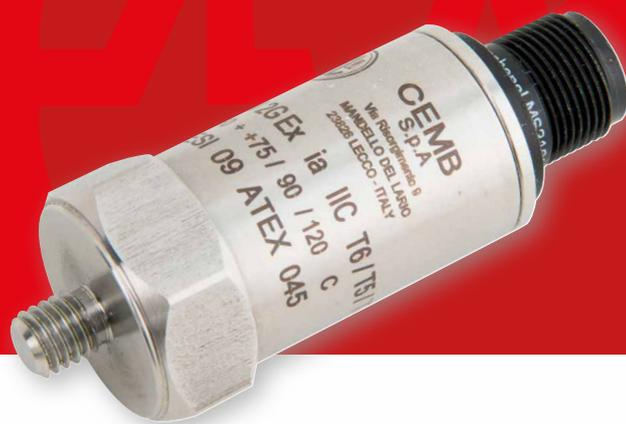
Il trasmettitore integrato TR-26 misura le Vibrazioni Assolute del supporto di una qualsiasi macchina rotante ed è in grado di interfacciarsi direttamente in tecnica 2 fili (loop di corrente 4 ÷ 20 mA) ad un sistema di acquisizione (PLC o DCS).
