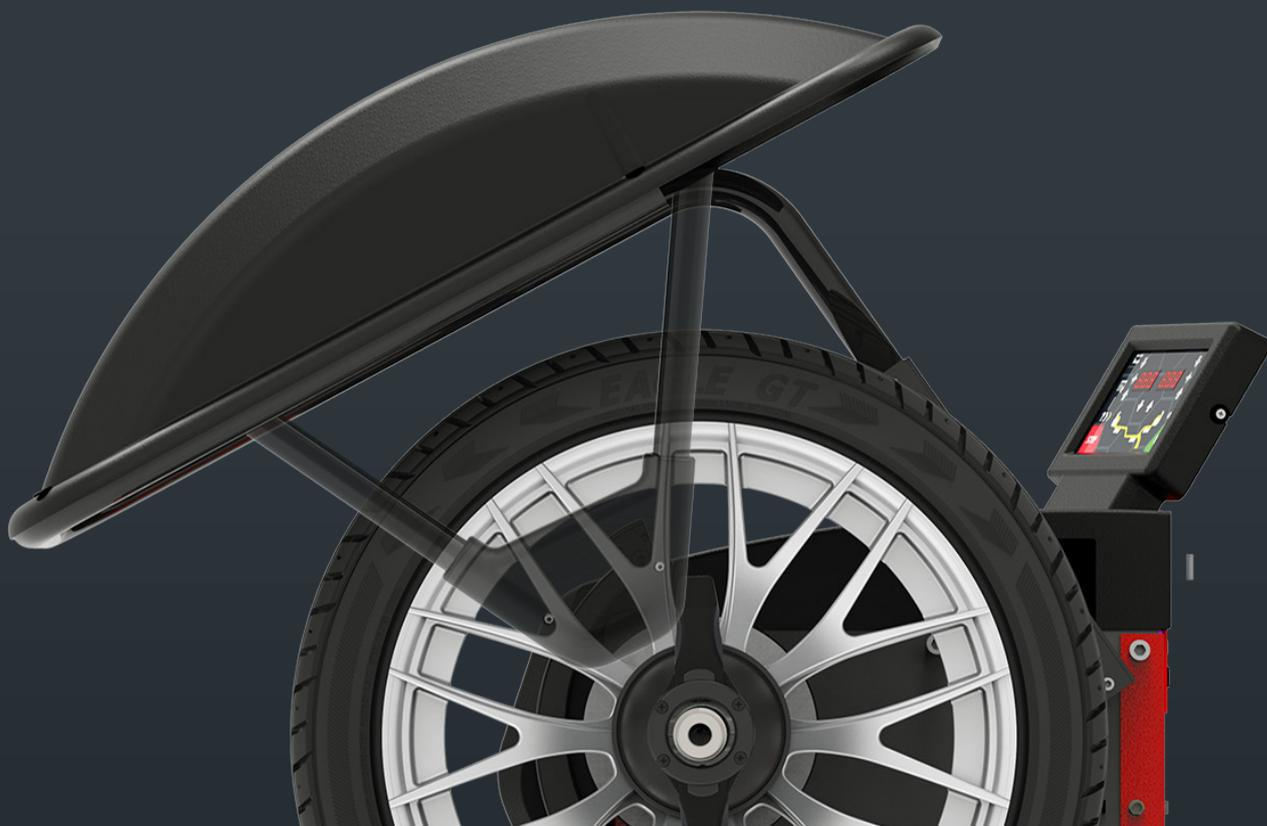
Con l'acquisizione di distanza e diametro del primo piano tramite calibro automatico, **Virtual Sonar** calcola tutte le possibili combinazioni di offset e di larghezze del cerchio in cui il secondo piano di correzione può essere collocato.
