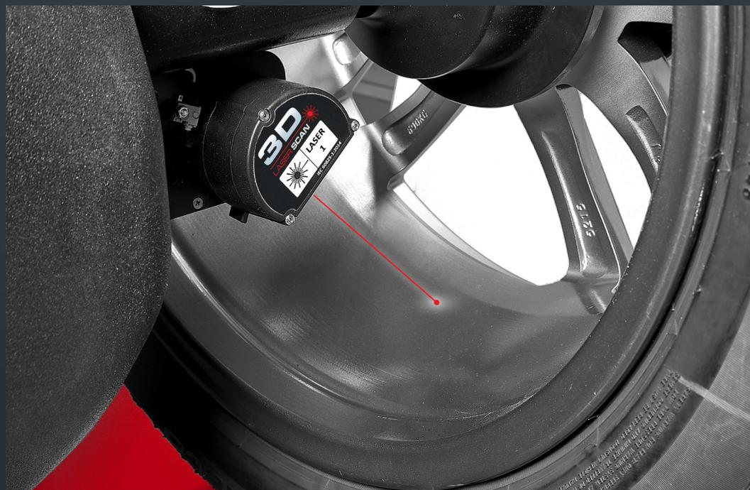
Durante la fase di correzione, il **3D Laser Scan** individua la posizione esatta per l'applicazione dei contrappesi adesivi all'interno del cerchio. Eventuali errori durante l'applicazione del peso vengono azzerati grazie al freno elettrico, che blocca la ruota nell'esatta posizione dello squilibrio.
