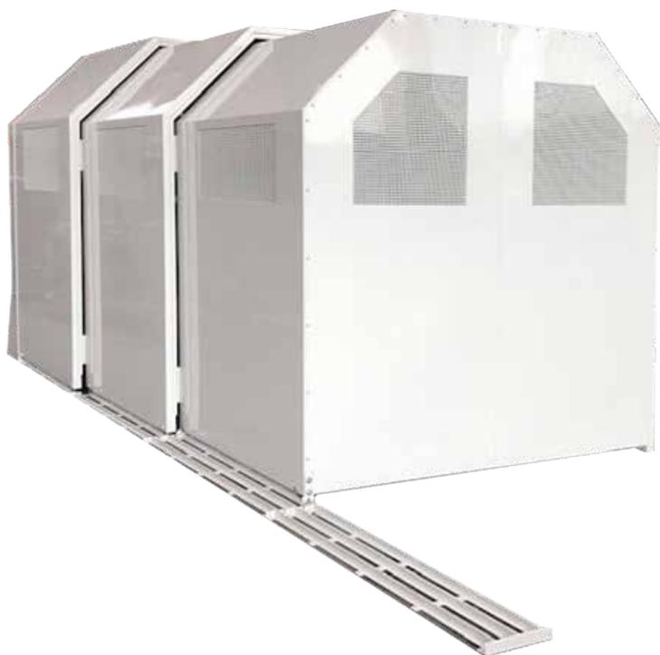
Esempio di protezione a del tipo "a tunnel", classe "C", scorrevole su apposite rotaie fissate al pavimento per permettere il carico e lo scarico del rotante da equilibrare: apertura e chiusura manuali da parte dell'operatore.
