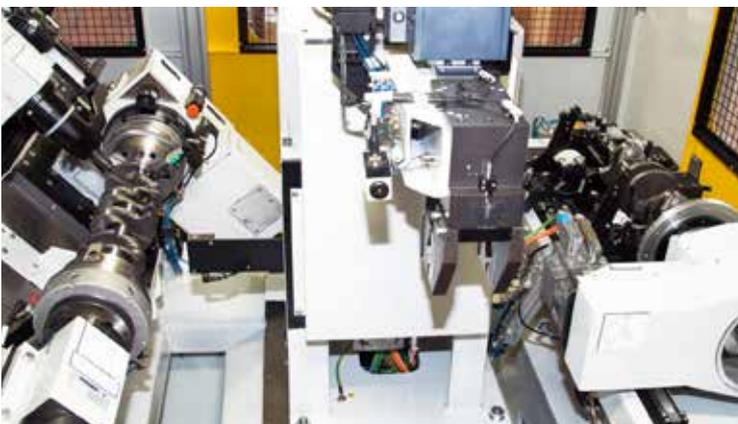
Impianto automatico per il controllo e la correzione di alberi a gomito, a due stazioni, con tempo ciclo ridotto.
