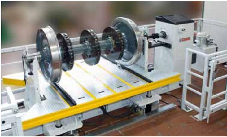
Equilibratrice ad asse orizzontale per sale ferroviarie provvista di sollevatore idraulico e trascinamento con giunto cardanico.
