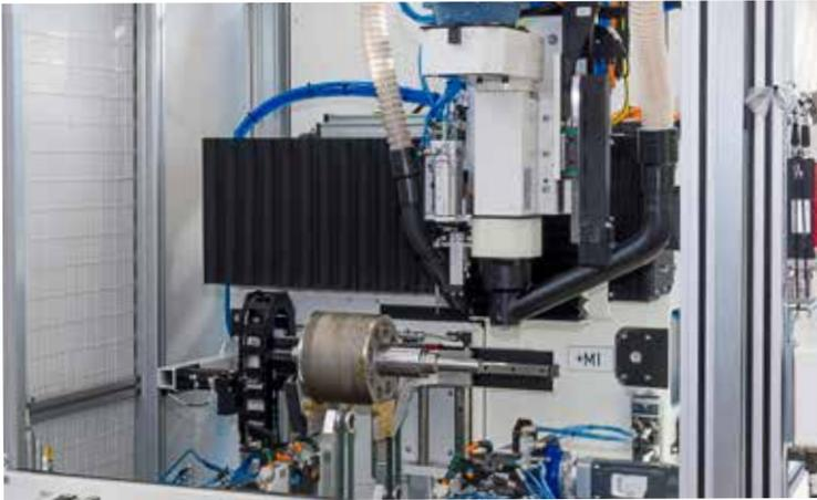
Equilibratrice con misura squilibrio su due piani con trascinamento a cinghia tangenziale e correzione per foratura radiale tramite unità verticale ad assi controllati
