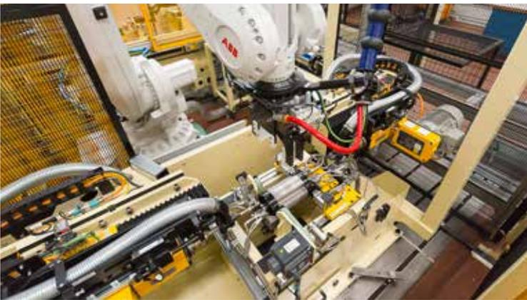
Impianto di equilibratura composto da cella robotizzata con due macchine equilibratrici, ognuna con funzione di misura e di correzione squilibrio. Il robot antropomorfo carica e scarica i pezzi dalla linea pallet del cliente sulle macchine equilibratrici e può anche caricare i rotori master da depositi interni.
