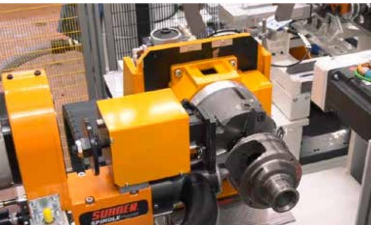
Impianto automatico di equilibratura ad asse orizzontale con correzione dello squilibrio mediante foratura. Un caricatore esegue i movimenti di carico, trasferimento e scarico pezzi.
