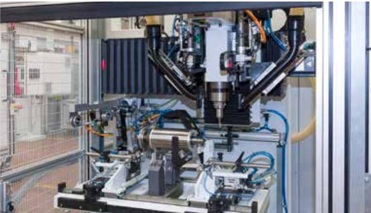
Equilibratrice per rotor di motori elettrici. Correzione automatica per fresatura radiale sui dischi di correzione.
