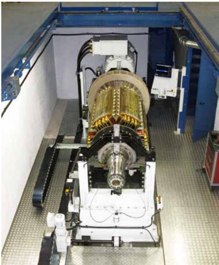
Equilibratrice con trascinamento a giunto ad alta velocità (fino a 4200 RPM) per indotti di motori elettrici.
