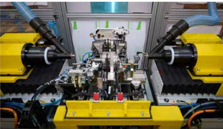
Equilibratrice per rotor di motori elettrici. Correzione automatica su due piani con trascinamento a cinghia e correzione per foratura assiale sui fianchi tramite due unità contrapposte ad assi controllati.
